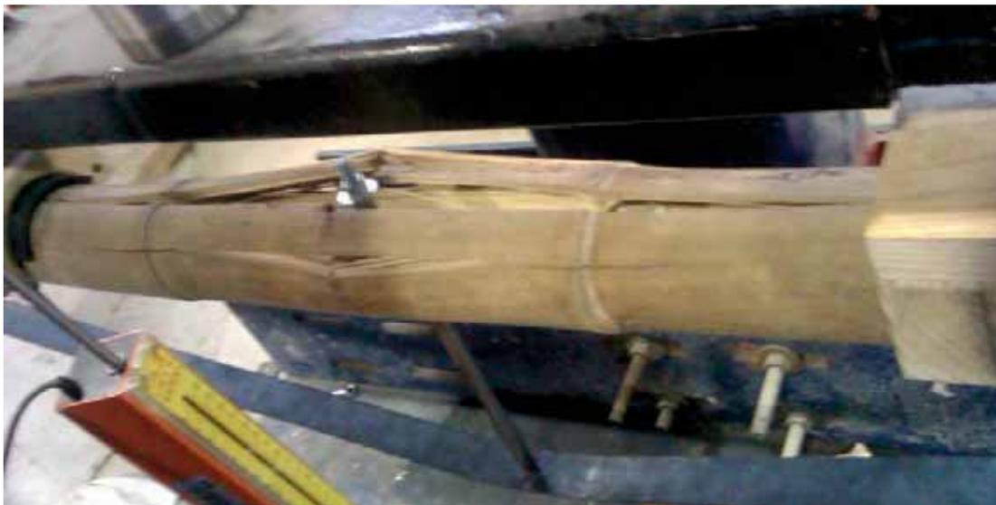
**Figura 58.- Falla; fisura en la parte superior central.**
