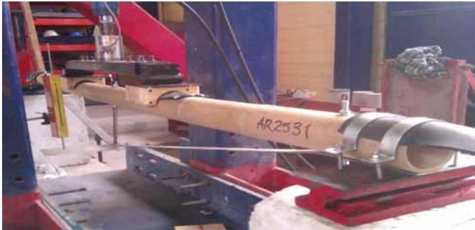
Figura 51.- Aplicación de carga.
