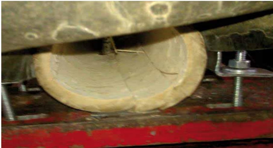
Figura 86.- Falla; aplastamiento en el extremo derecho.
