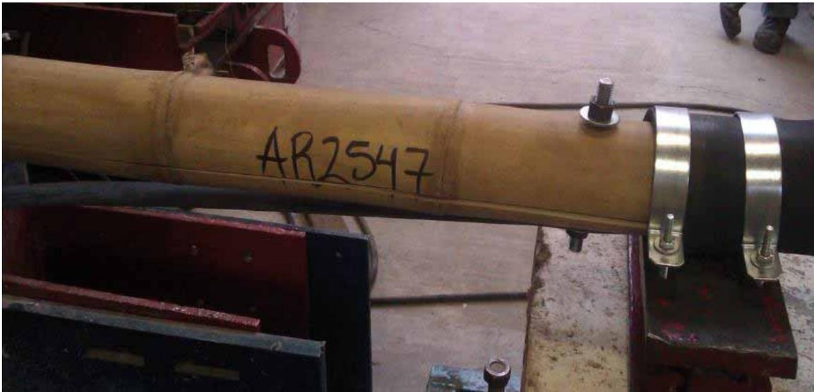
Figura 89.- Falla; rajadura en el lado derecho del ensaye.
