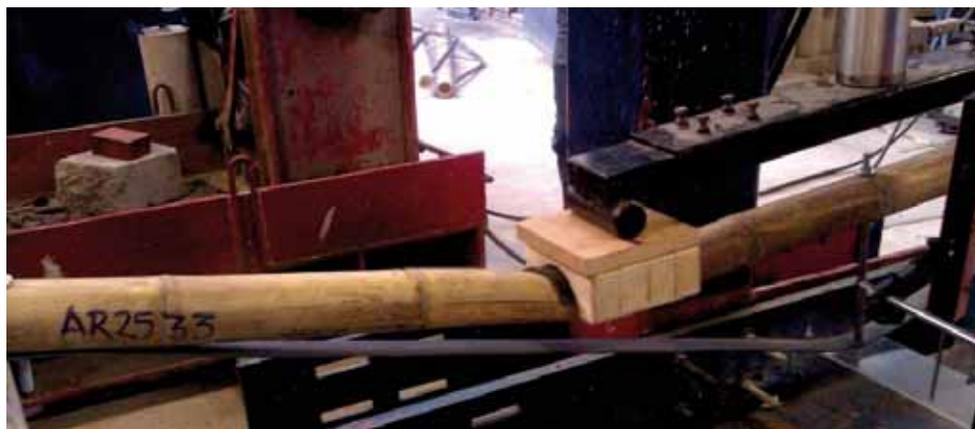
**Figura 55.- Aplicación de la carga y falla en la zona de la aplicación de la carga.**
