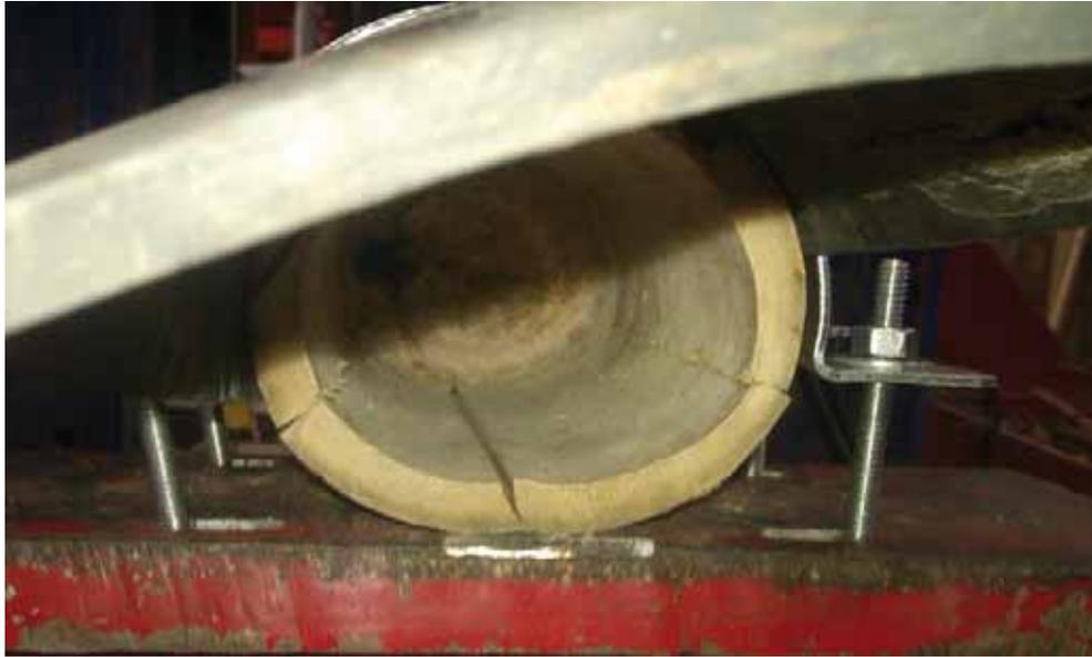
**Figura 91.- Falla; aplastamiento en el extremo derecho.**
