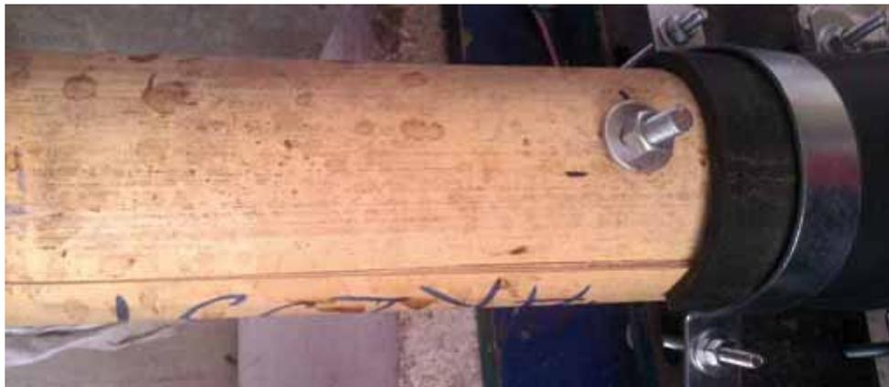
Figura 52.- Falla; rajadura del apoyo a 1/3 de la longitud.
