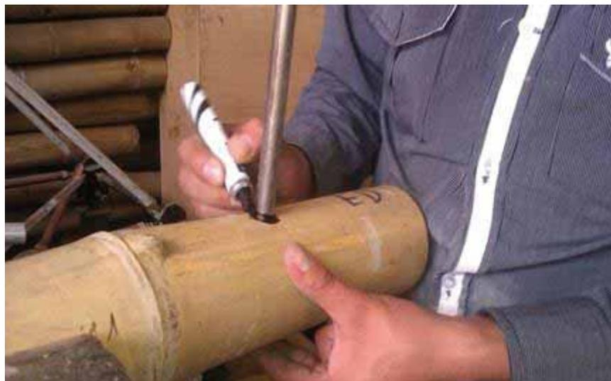
**Figura 15.- Marcado y corte del tubo.**
