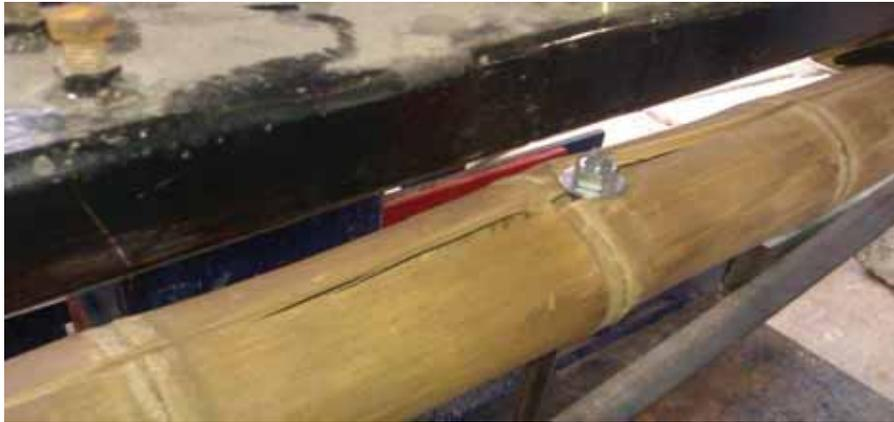
Figura 77.- Falla; rajadura en la parte superior de la parte central del culmo.
