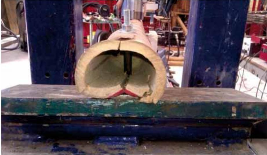
Figura 44.- Falla por aplastamiento vista transversal.
