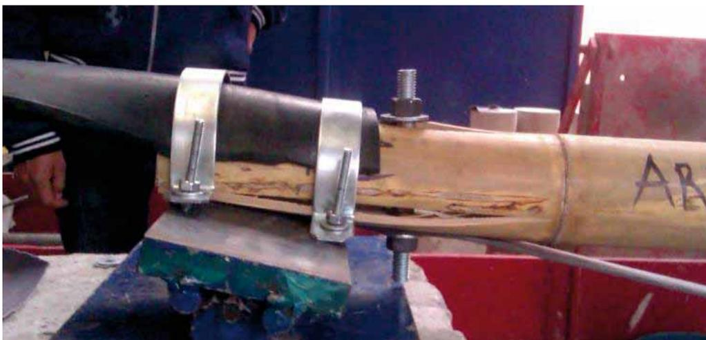
**Figura 70.- Falla; por aplastamiento vista lateral.**
