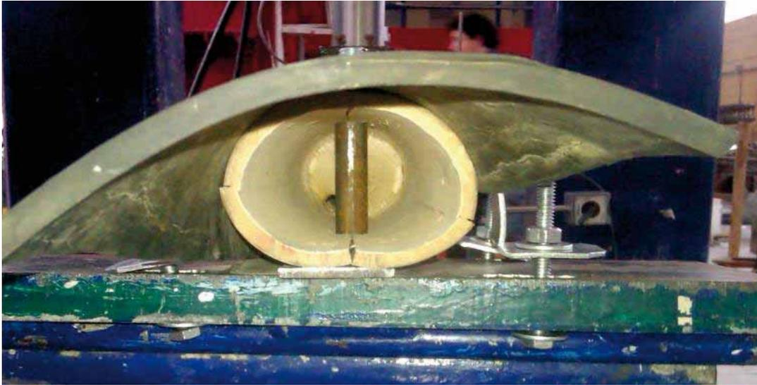
Figura 71.- Falla; por aplastamiento vista transversal.
