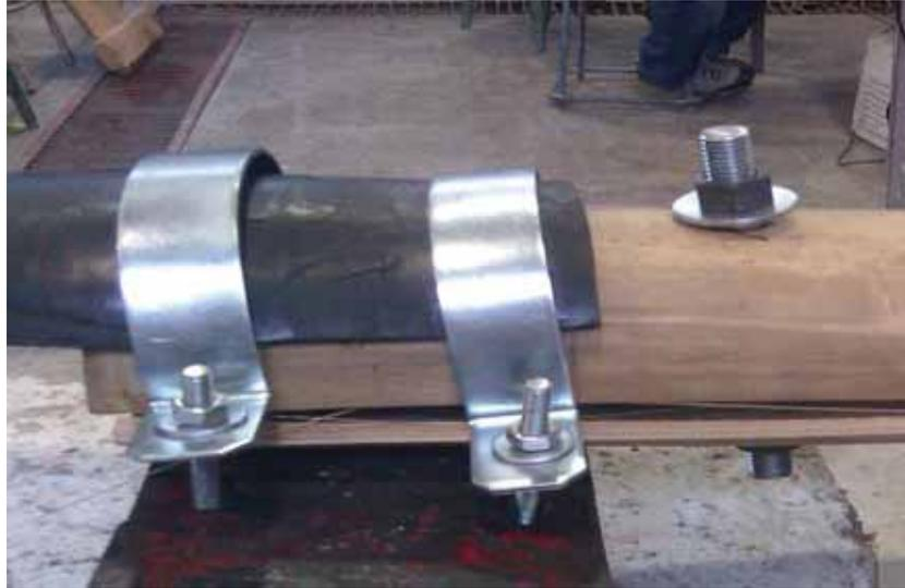
**Figura 30.- Extremos sujetados para restricción del giro.**
