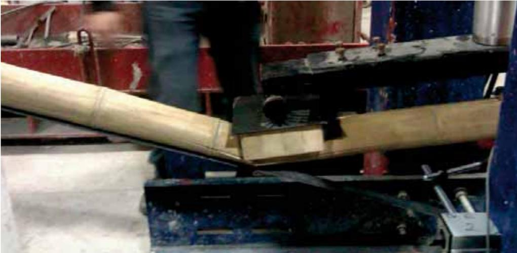
Figura 68.- Falla; aplastamiento y desgarre en la zona de aplicación de la carga.
