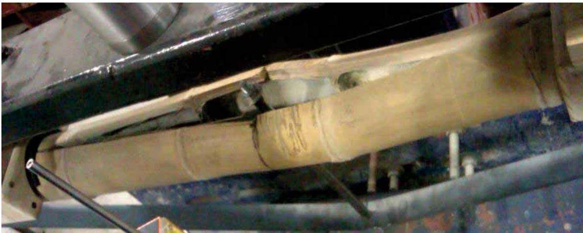
**Figura 59.- Falla; fisura en la parte superior central.**
