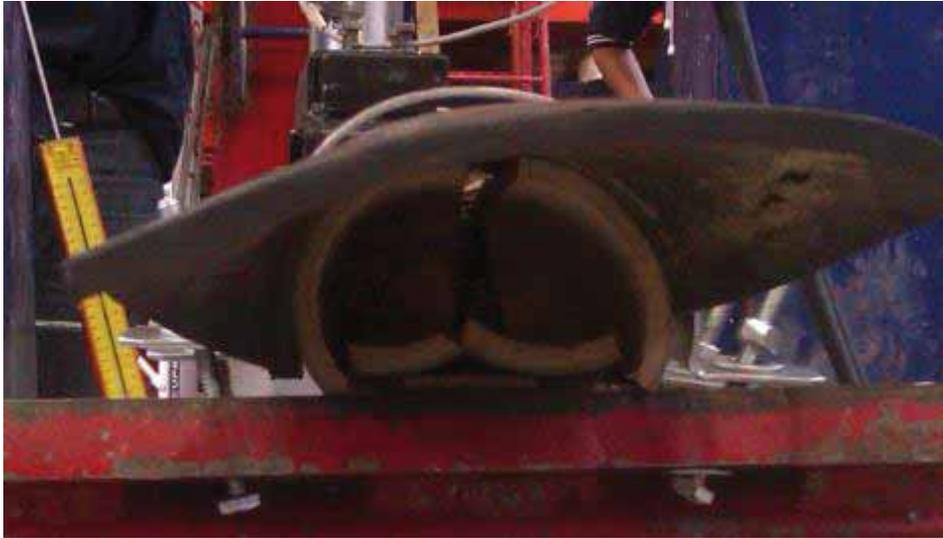
**Figura 80.- Falla; aplastamiento en el extremo derecho.**
