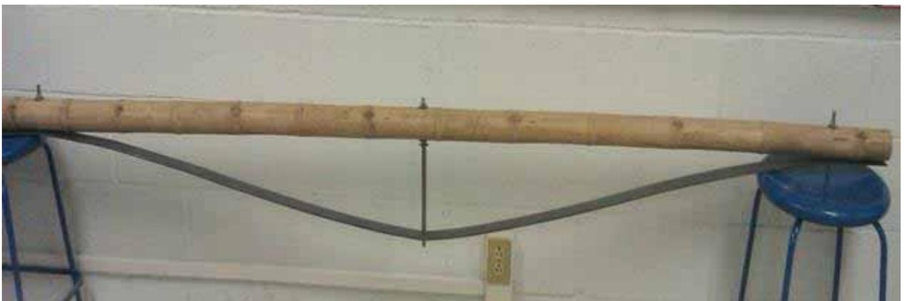
**Figura 23.- Armadura plana de bambú completa.**
