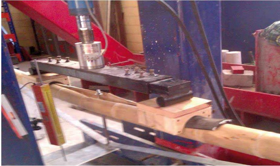
Figura 50.- Falla; rajadura en la parte superior central.
