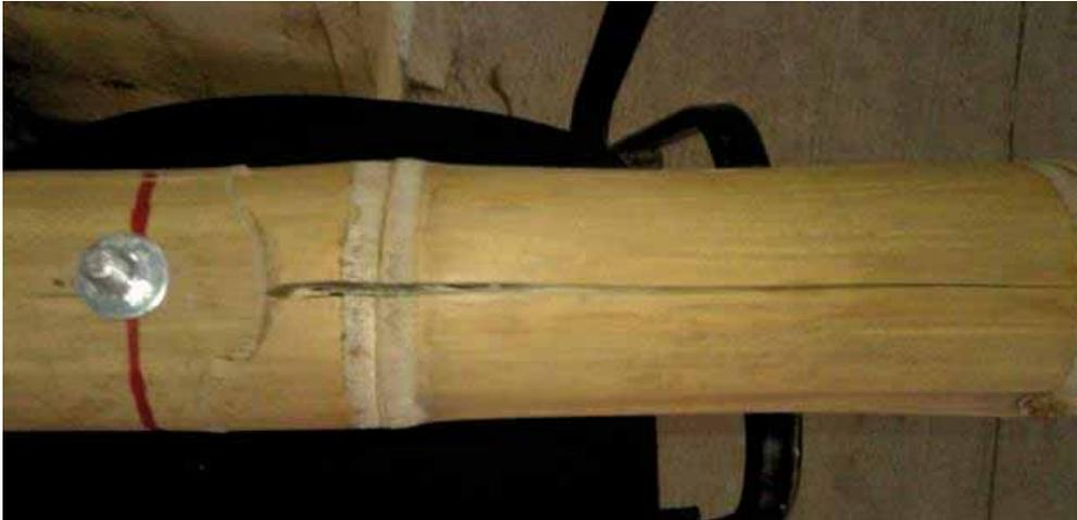
Figura 39.- Corte en el culmo por aplastamiento.
