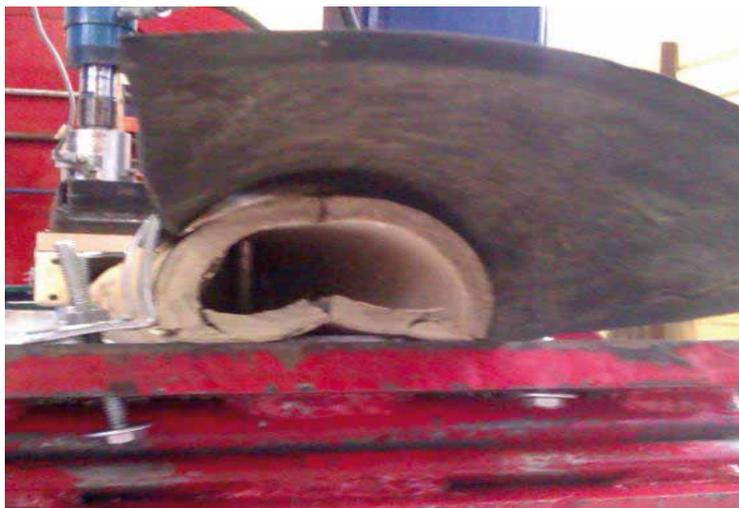
**Figura 54.- Falla; aplastamiento en el extremo derecho.**
