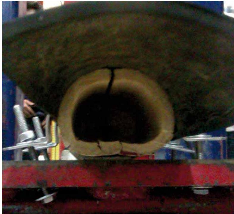
Figura 61.- Falla; aplastamiento en el extremo derecho.
