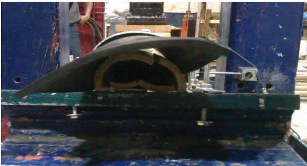
**Figura 63.- Falla; aplastamiento en el extremo izquierdo.**
