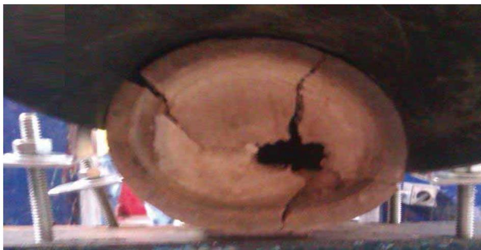
Figura 53.- Falla; aplastamiento en el extremo izquierdo.
