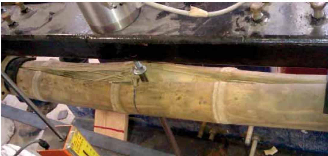
**Figura 73.- Falla; rajadura en la parte superior de la parte central del culmo.**
