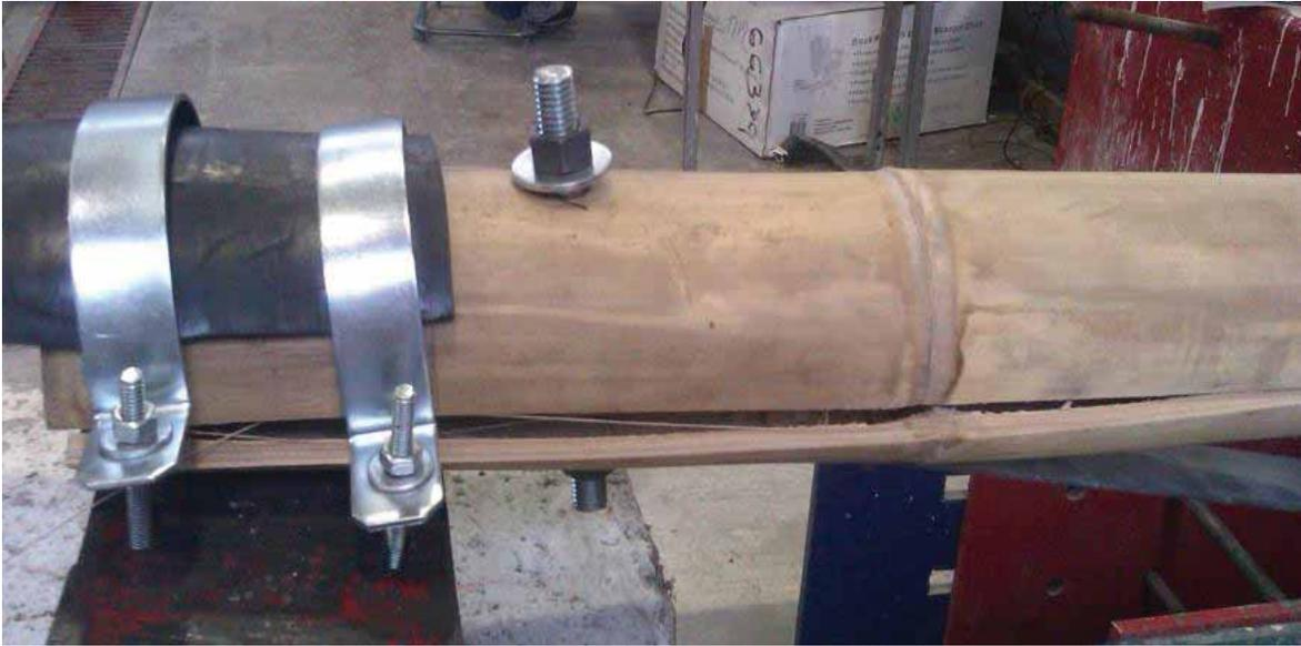
Figura 88.- Falla; aplastamiento en el extremo derecho.
