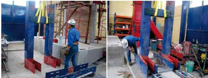
**Figura 24.- Ensamble del acero y fijado a la cimentación del dispositivo.**
