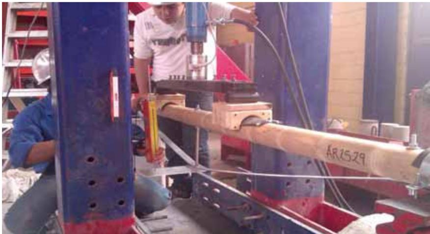
**Figura 49.- Colocación del deformímetro sobre la placa de vidrio plástico.**
