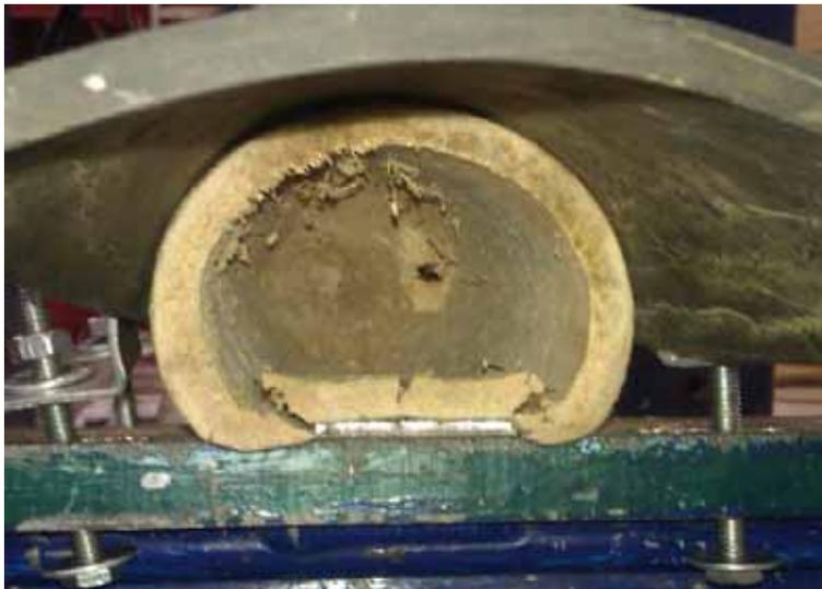
Figura 78.- Falla; aplastamiento en el extremo izquierdo.
