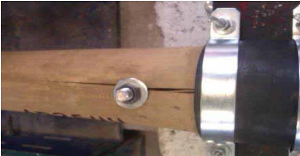
**Figura 81.- Falla; rajadura en la zona del esparrago en el lado derecho del ensaye.**
