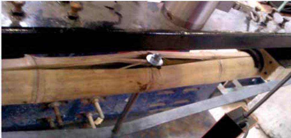
Figura 75.- Falla; rajadura en la parte superior de la parte central del culmo.
