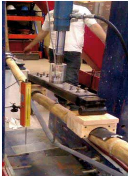
Figura 56.- Vista longitudinal de la falla en la probeta.
