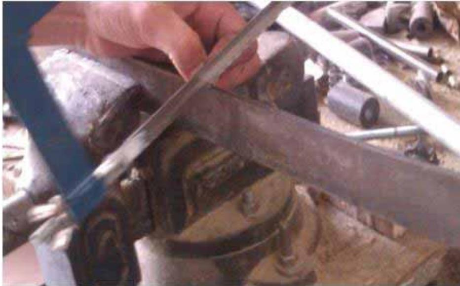
**Figura 16.- Corte de la solera.**
