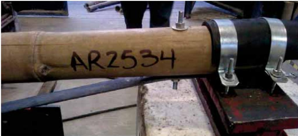
**Figura 57.- Rajadura en el extremo derecho.**
